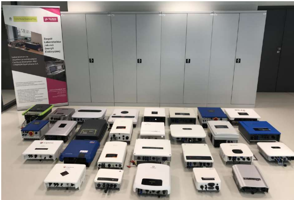
Rys. 3. Zdjęcie zbiorcze większości badanych falowników PV
